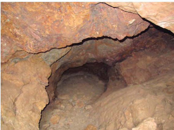
Fig. 67.4. Interior del socavón inferior con el fondo colmatado de sedimento y la cámara lateral a la derecha para seguir el filón.
