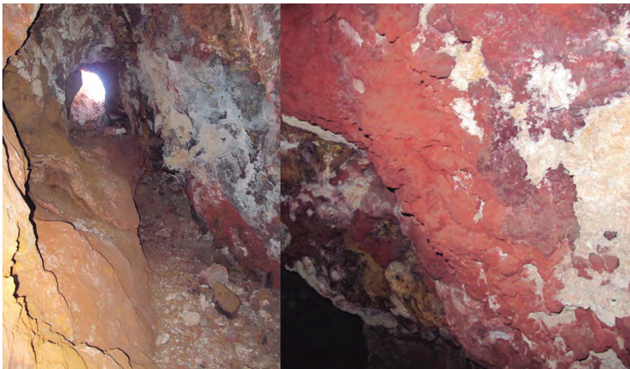
Fig. 68.3. Izquierda: Interior de galería abierta en la Cantera muy irregular y siguiendo el filón. Se observa un tramo fuertemente mineralizado de óxidos de hierro a la derecha. Derecha: detalle de la mineralización anterior.
