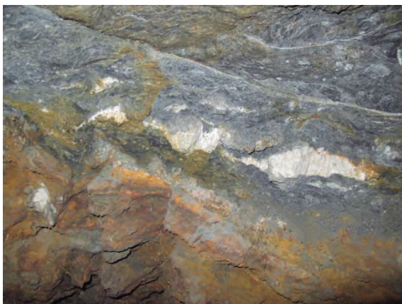
Fig. 63.5. Interior del socavón Este, contacto entre esquistos cuarcíticos y las cuarcitas mineralizadas de hierro.
