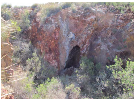
Fig. 68.1. Galería abierta en la cantera principal del indicio. La bocamina tiene más de dos metros de altura.
