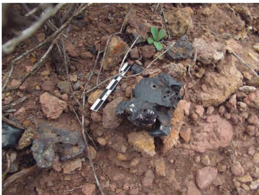
72.2. Escorias con alto contenido férrico y granos de sílice sin fundir en la escombrera de la labor 2.
