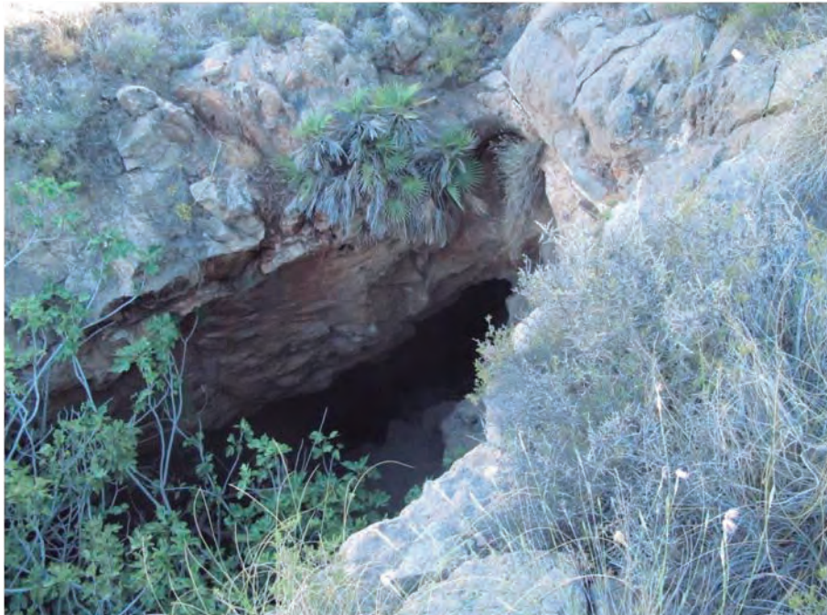
Fig. 79.20. Pequeña rafa o cantera en la que se han abierto labores en profundidad (no exploradas). La parte superior de la cantera está seccionado antiguas labores en forma de galerías sub-horizontales, como las vistas en 79.11 o 79.16. En este caso mucho más claras.
