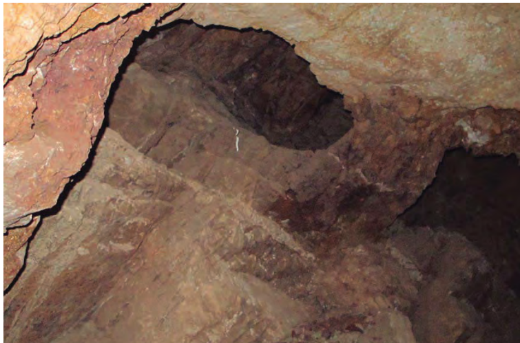
Fig. 67.11. Galería antigua seccionada por labores modernas que dejaron un pilar de sustentación. Este pilar, picado recientemente por coleccionistas de minerales está fuertemente mineralizado.
