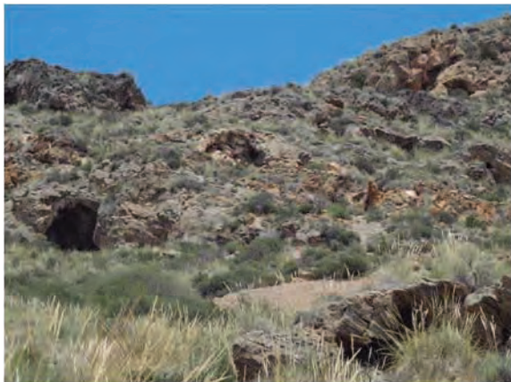
Fig. 65.1. Imagen general de la mina en la que se observa la escombrera en primer plano a la derecha; un poco más arriba la galería de salida y por detrás una oquedad que es el socavón de acceso con la terraplén de mampostería a la derecha.
