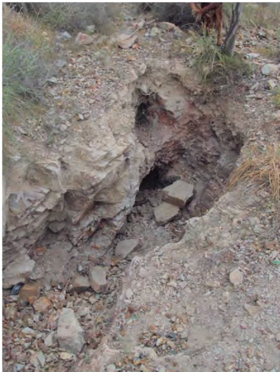
Fig. 58.3. Interior de la calicata desde arriba. Se observan varios agujeros y bloques de gran tamaño arrancados por los coleccionistas de minerales. Los bloques del fondo marcan el inicio de la galería.
