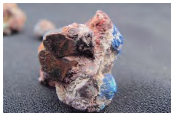
Fig. 62.7. Detalle de piritoedro con mineralización de azurita.
