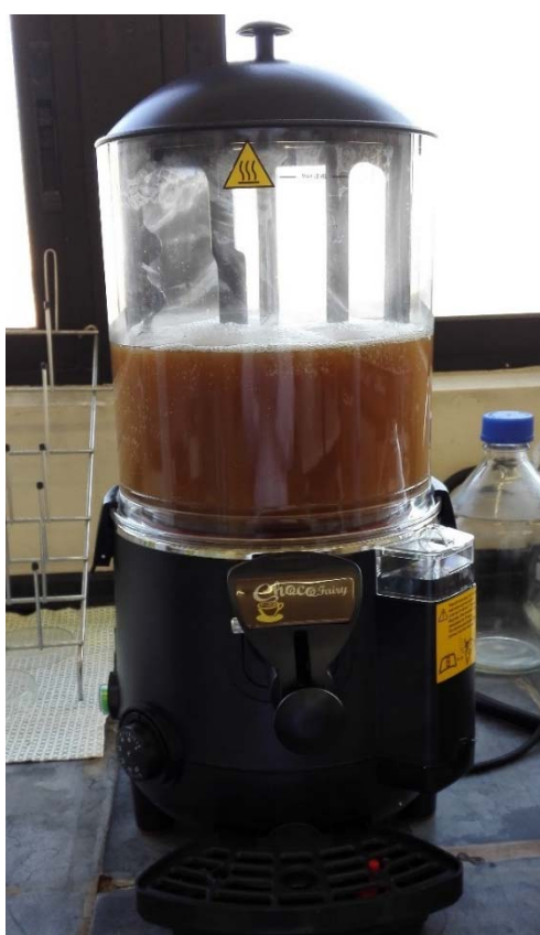
Fotografía 10. Equipo de agitación y mantención de temperatura con cultivo de Lactobacillus plantarum Ca7.
