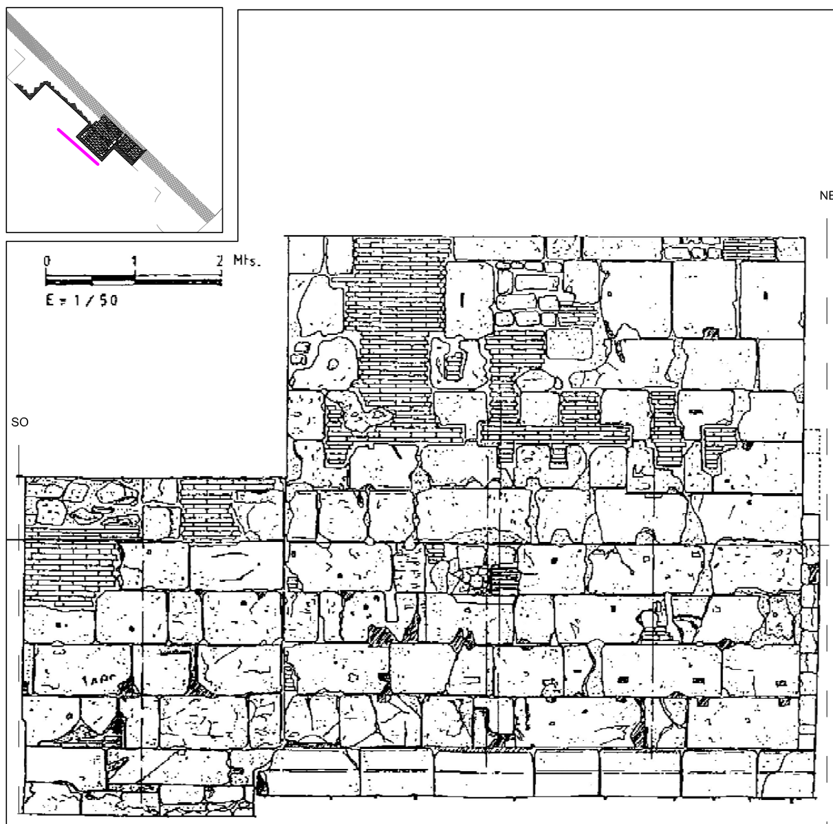
Alçat 26: Torre XIII/2 (torre 62 de la numeració tradicional) i llenç entre aquesta i la torre XIII/3 (torre 63). Alçat SO.
