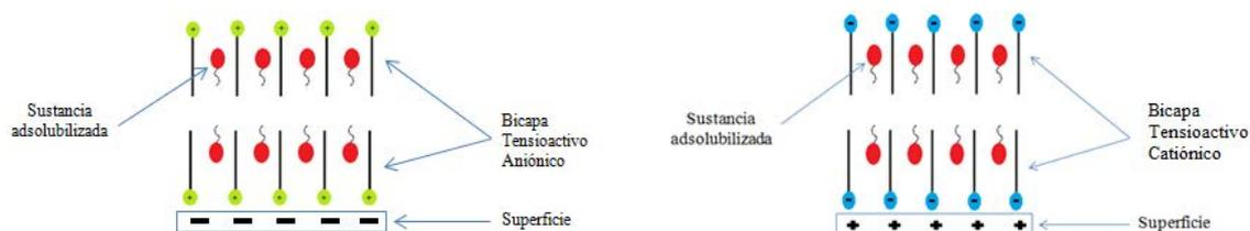
Figura 1. Fenómeno de la adsolubilización, mediante el cual se incorporan compuestos orgánicos en el interior de bicapas de tensioactivos adsorbidos sobre una superficie polar.
