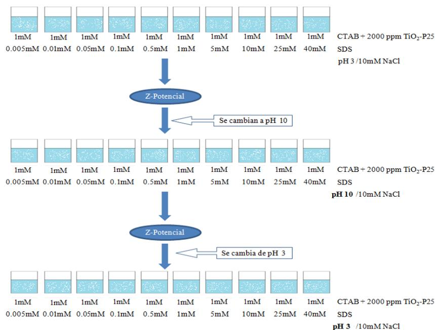
Figura 163.- Esquema del test realizado con 1mM de CTAB y diferentes concentraciones de SDS.
