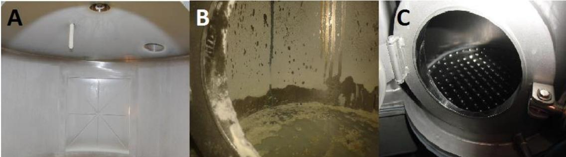
Figura 32. Atomizador. A) Después de la producción de leche en polvo. B) Durante el primer enjuague. C) Después de la limpieza enzimática.
