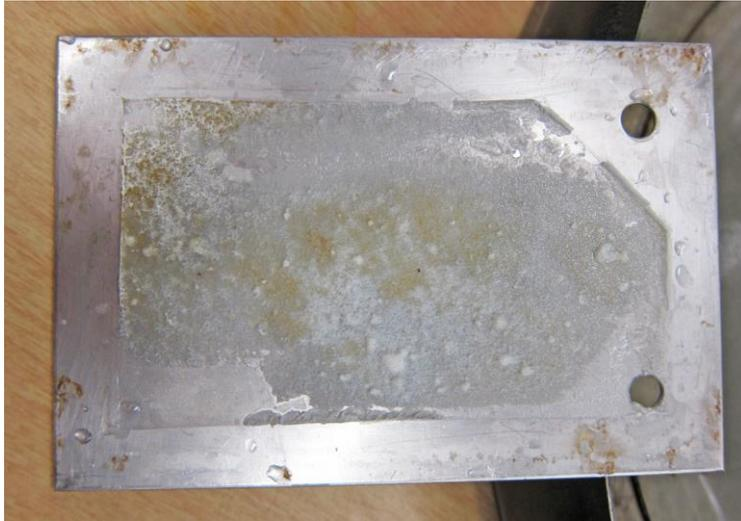
**Figura 4: PHE de acero inoxidable 316 después de pasteurizar leche durante 8 horas (Barish y Goddard, 2013).**
