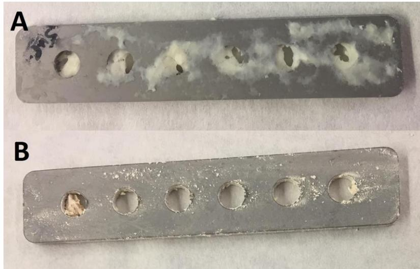
**Figura 36. Muestreadores de un pasteurizador. A) Después de 1 h a 105°C, produciéndose fouling lácteo tipo A. B) Después de 4 h a 135°C, produciéndose fouling lácteo tipo B.**
