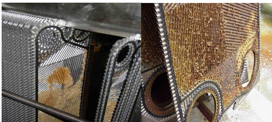
Figura 5. PHE obturado por la acumulación de fouling caramelizado (Anónimo, 2007).
