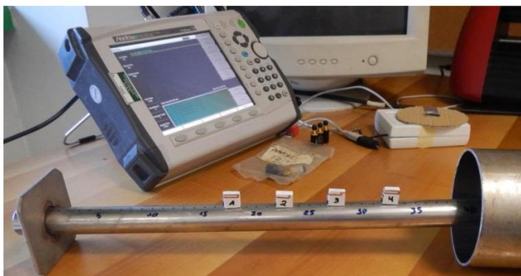
Fig.1.13: Maqueta utilizada durante las medidas con dos sondas que no aparecen en la imagen y cuatro sensores en el interior.
