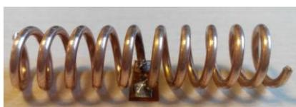
Fig.5.5: Prototipo de la antena helicoidal cilíndrica.
