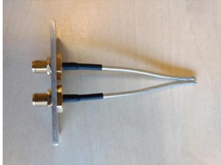
Fig.2.2: Accesorio usado en las medidas diferenciales de las antenas diseñadas.
