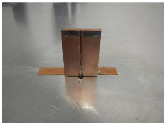
Fig.4.19: Fotografía de media antena sobre un plano de masa utilizado para la medida de la impedancia de la antena en espacio libre mediante el proceso descrito en la sección 2.7.2.1.
