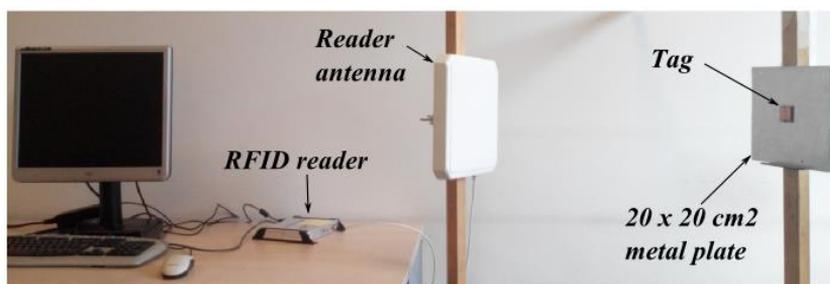
Fig.4.39: Set-up de medida del rango de lectura.
