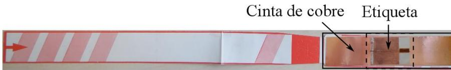
Fig.4.42: Ilustración de la estructura de la cinta identificativa.
