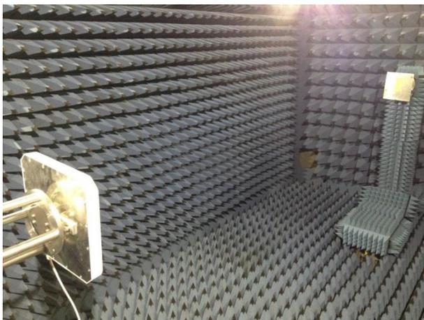
Fig.2.3: Escenario de medida de la potencia de activación en la cámara anecoica.
