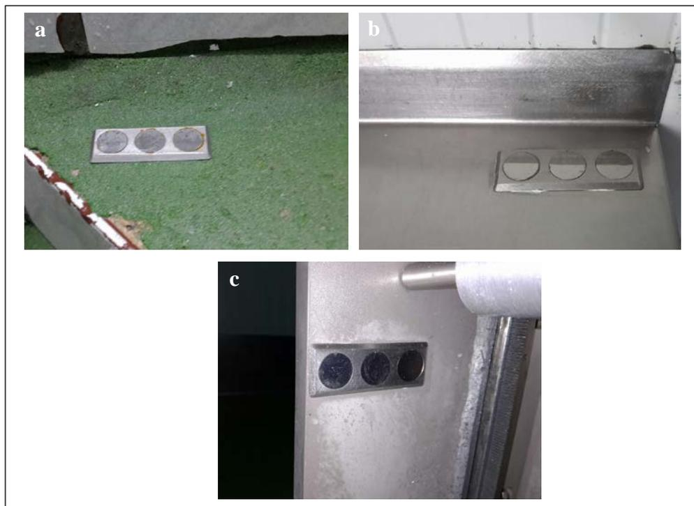
**Figura 12.** Colocación de los sensores SCH con sus respectivos cupones de acero inoxidable en diferentes superficies de la planta B, siendo (a) el suelo del lavadero de los carros de fresco; (b) la mesa de loncheado; y (c) el lateral de la envasadora al vacío.
