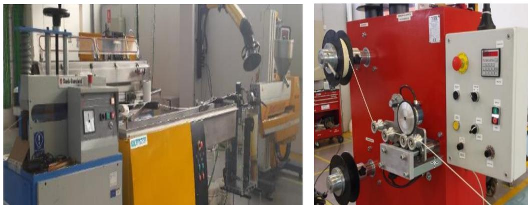
Figura 15. Línea de filamentado mediante extrusión mono-husillo.
