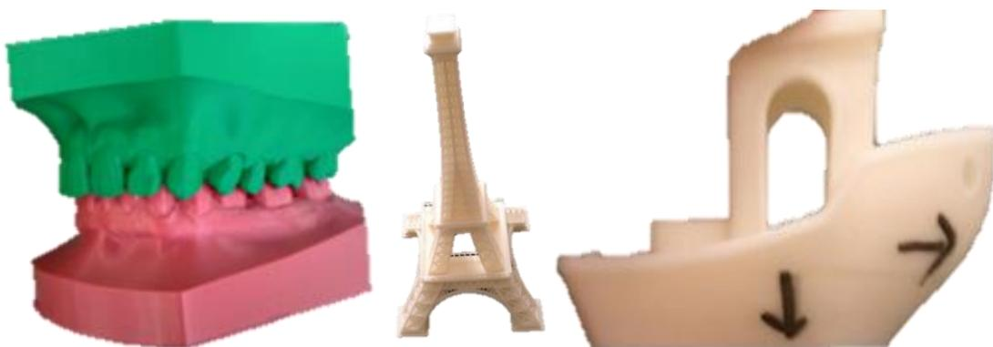
**Figura 14. Piezas de aplicación final mediante tecnología FDM.**
