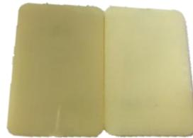
**Figura 9. Comparativa de piezas inyectadas después del test de resistencia a la intemperie. Muestra con acrilato (derecha) y muestra de ABS (izquierda).**
