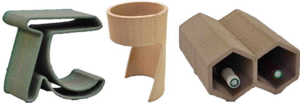
**Figura 8. Diferentes piezas inyectadas mediante extrusión en impresión 3D con el material compuesto de ABS desarrollado.**
