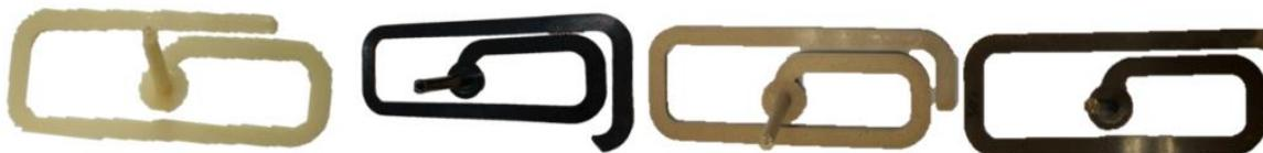
Figura 3. Pruebas de flujo en espiral: 1- ABS de control. 2- ABS reforzado con fibra de vidrio.
