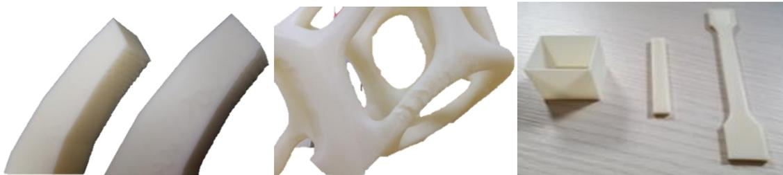
**Figura 13. Piezas impresas mediante FDM para el estudio de las propiedades de adhesión y alabeo.**
