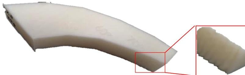
Figura 3. Pieza angulada para observar la adhesión entre capas.
