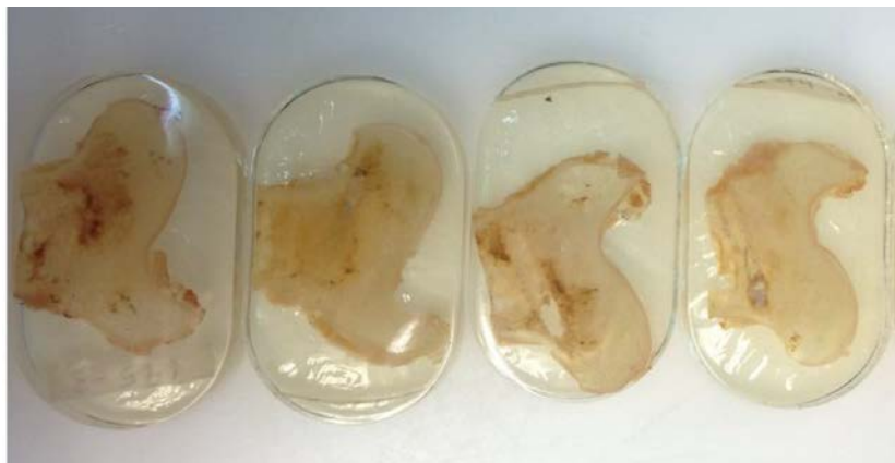
Figura 3.15. Imágenes representativas de los bloques sólidos de resina de PMMA con las muestras óseas embebidas en su interior una vez fotopolimerizadas.
