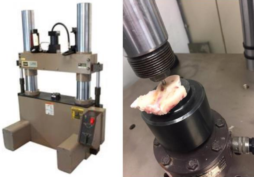
Figura 3.12. Imagen representativa del procedimiento de ensayo biomecánico de indentación con la máquina servohidráulica Bionix.
