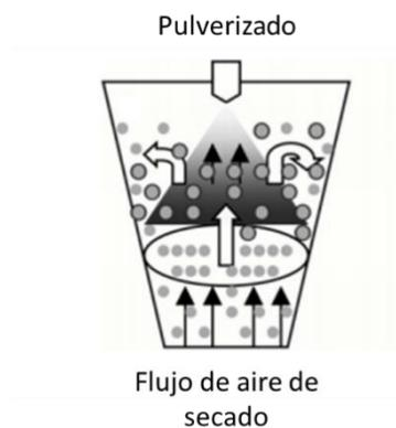
**Figura 1.13.** Representación esquemática del funcionamiento de un lecho fluido, en este caso del tipo Top-spray [20].
