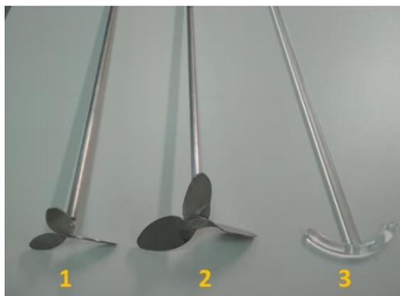
**Figura 6.1.** Fotografía de las 3 varillas agitadoras usadas en las reacciones de escalado.
