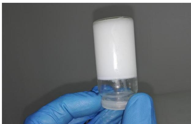
**Figura 7.9.** Suspensión de microcápsulas tras 7 días con el uso de gelatina como estabilizante.
