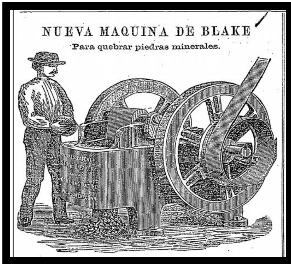
Figura 2.4 Máquina para quebrar piedras minerales
