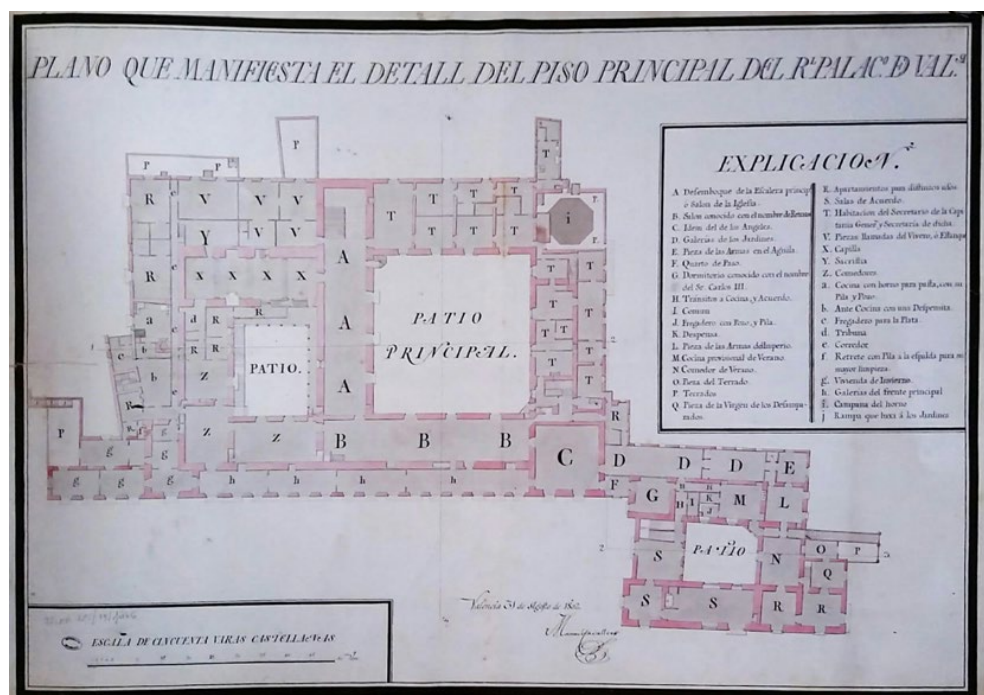
Fig. 3.42. Plano del piso principal del palacio Real de Valencia según Manuel Cavallero en 1802. Véase el Salón de los Retratos (letra B) y el Salón de los Ángeles (letra C).
