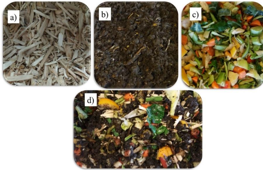
Figura 3.3. Mezcla de digestato y FORM estructurada con astillas de madera. a) Astillas de madera, b) Digestato, c) FORM, d) Mezcla digestato, FORM y astillas de madera para FES. Utilizada en los capítulos 7 y 8.
