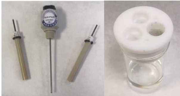
Figura 19. Imagen de los electrodos y la celda electroquímica.
