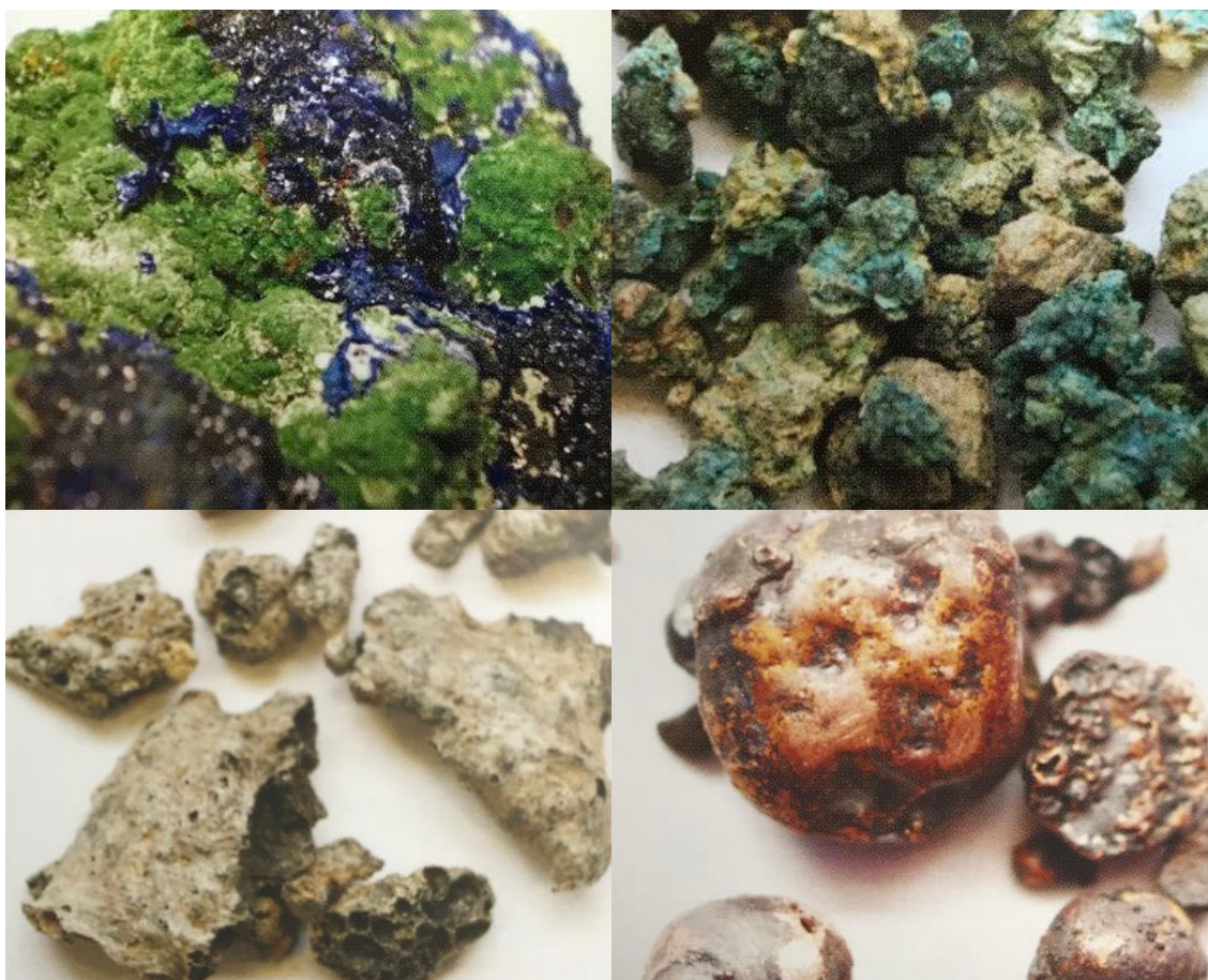
Fig. 3.70 - Mineral extraído (alto izq.), mineral triturado (alto dx.), escorias de carbonato (bajo izq.) y goterones de metal (bajo dx.). CONSUEGRA S. y DÍAZ DEL RÍO P. 2013.
