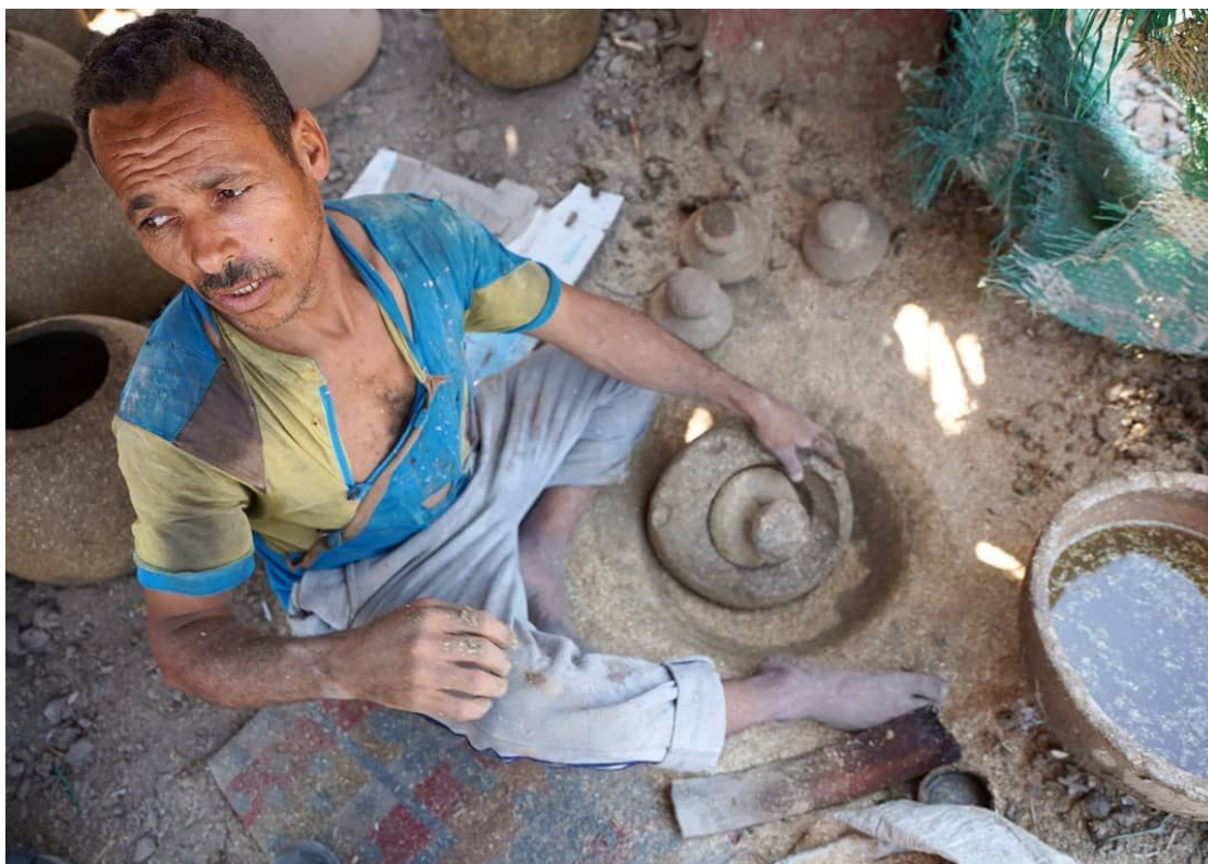
Figura 4.18. Un alfarero tradicional del municipio de El-Nazla (Fayum, Egipto) elabora recipientes estandarizados a partir de un molde recortado en el suelo (Fotografía de Denéa Buckingham)
