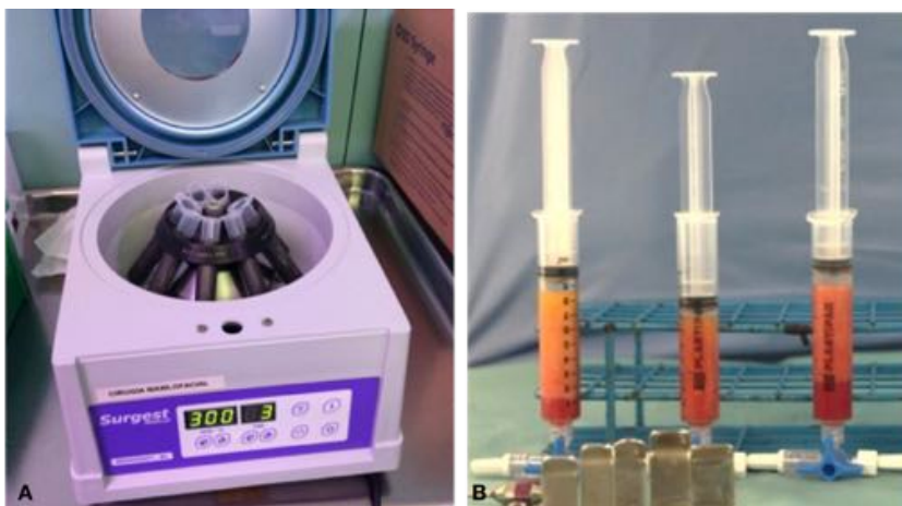
Figura 11: A. Centrifugadora con las jeringas que contienen el injerto de grasa autóloga recolectado, introducidas en las fundas metálicas estériles. B. Imagen de las jeringas tras la centrifugación donde se aprecian 3 capas: oleosa, grasa y solución residual.
