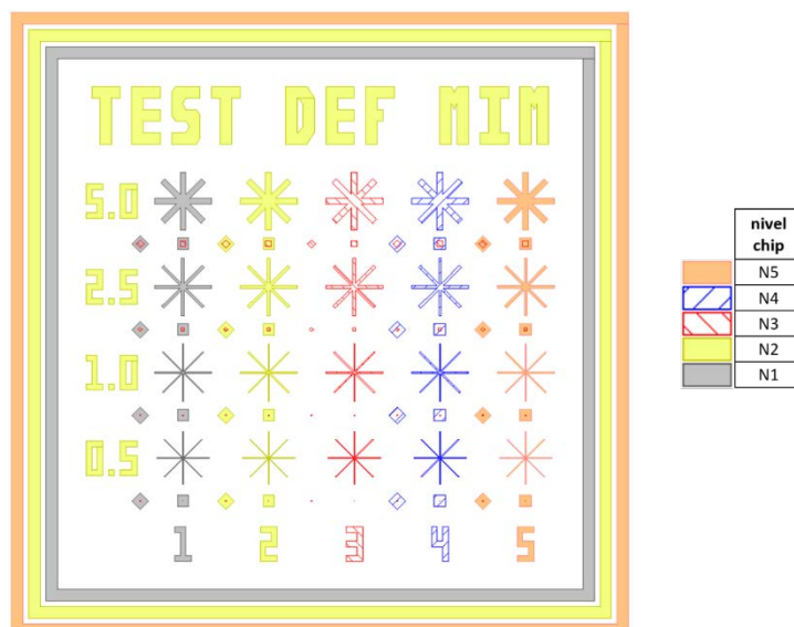
Figura 7-12. Diseño de los niveles fotolitográficos de la zona de test para la observación de la precisión de estructuras pequeñas situada en el tipo de chip 3 (ver Figura 7-4 ).
