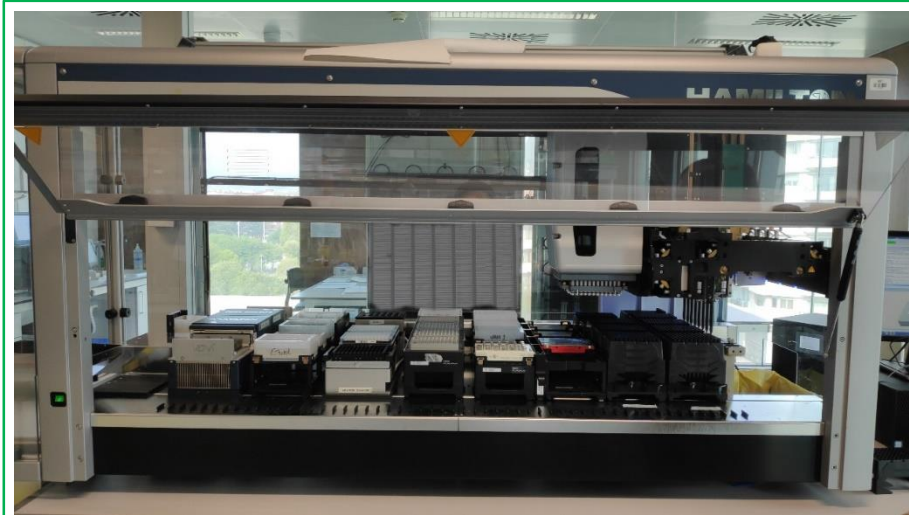
Figura 11. Fotografia del robot Hamilton Microlab Star M en funcionament. Programat per a preparar la llibreria genètica de les mostres a seqüenciar per la plataforma Illumina segons el protocol establert per al kit comercial NGSgo.
