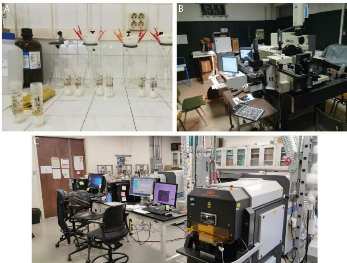
Figura 3.2. (A) Separació de minerals pesants amb líquid dens al Laboratori de Petrologia i Geoquímica de la Universitat Autònoma de Barcelona. (B) Equip d'espectrometria Raman del Institut de Ciència dels Materials. (C) Equip d'anàlisi geocronològic LA-ICP-MS del laboratori UTChron a la University of Texas en Austin (Jackson School of Geosciences).
