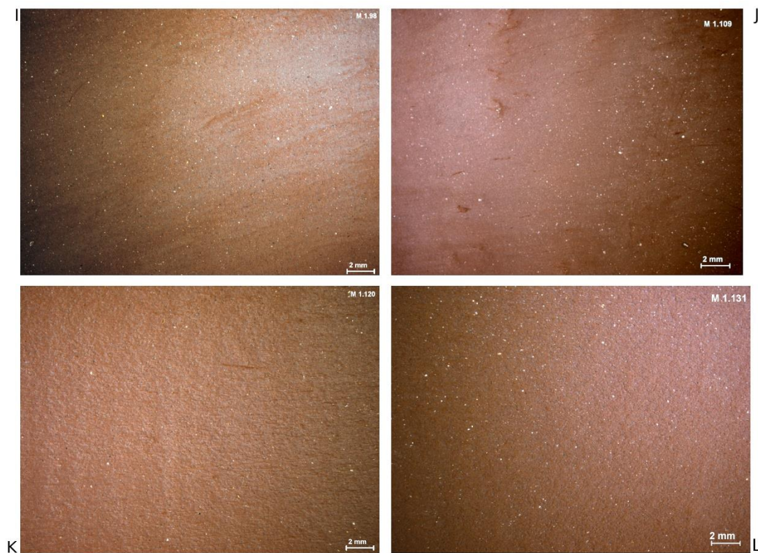
Figura 6.1.57 Evolución de las muestras experimentales trabajadas con fragmento de cuero. Pasta cerámica industrial. Inversión de trabajo elevada -10 minutos-. I: consistencia húmeda; J: consistencia cuero-verde; K: consistencia cuero-duro; L: consistencia seca
