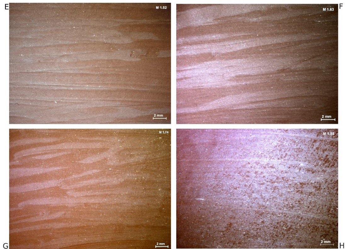
Figura 6.1.44 Evolución de las muestras experimentales trabajadas con espátula en malacofauna. Pasta cerámica industrial. Inversión de trabajo media -5 minutos-. E: consistencia húmeda; F: consistencia cuero-verde; G: consistencia cuero-duro; H: consistencia seca
