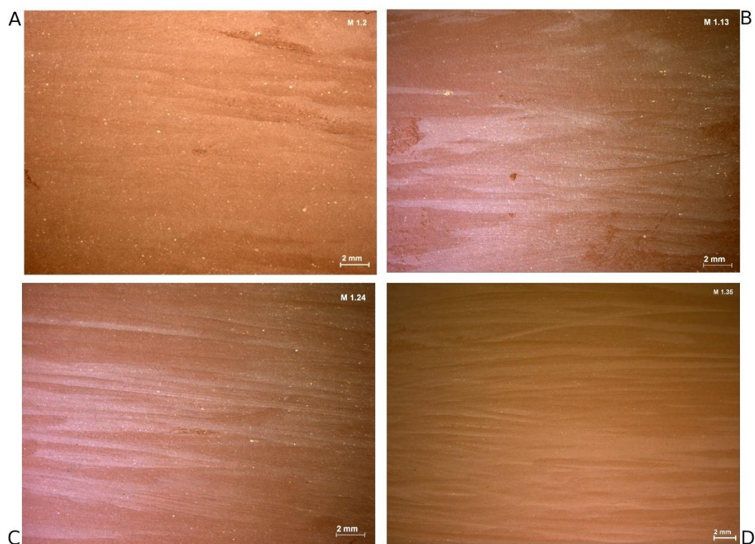
Figura 6.1.7 Evolución de las muestras experimentales trabajadas con espátula en sílex. Pasta cerámica industrial. Inversión de trabajo baja -2 minutos-. A: consistencia húmeda; B: consistencia cuero-verde; C: consistencia cuero-duro; D: consistencia seca
