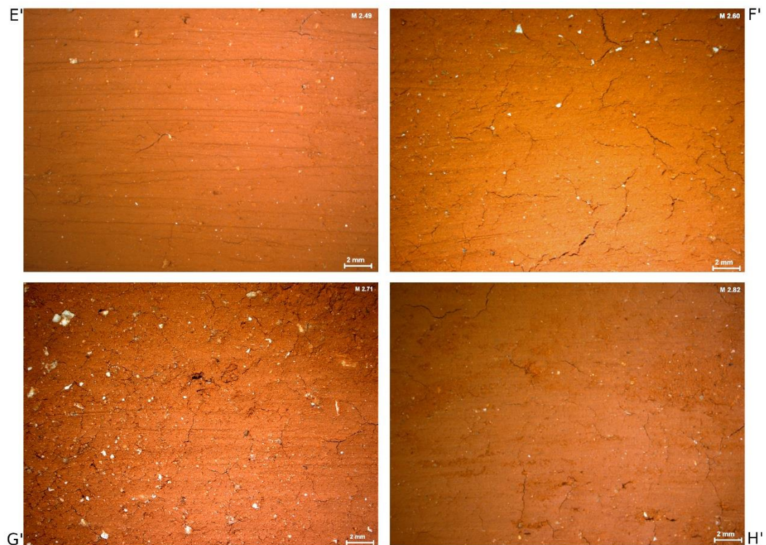
Figura 6.1.29 Evolución de las muestras experimentales trabajadas con espátula en cuerno. Pasta cerámica natural. Inversión de trabajo media -5 minutos-. E': consistencia húmeda; F': consistencia cuero-verde; G': consistencia cuero-duro; H': consistencia seca
