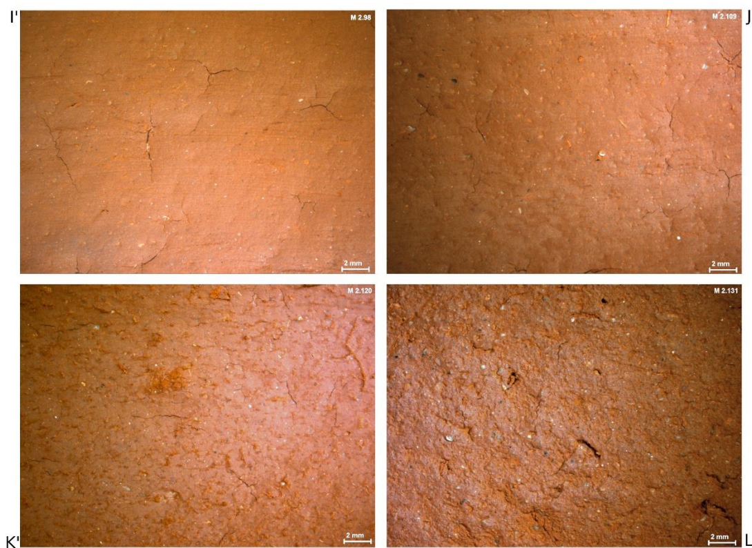
Figura 6.1.60 Evolución de las muestras experimentales trabajadas con fragmento de cuero.. Pasta cerámica natural. Inversión de trabajo alta -10 minutos-. I': consistencia húmeda; J': consistencia cuero-verde; K': consistencia cuero-duro; L': consistencia seca
