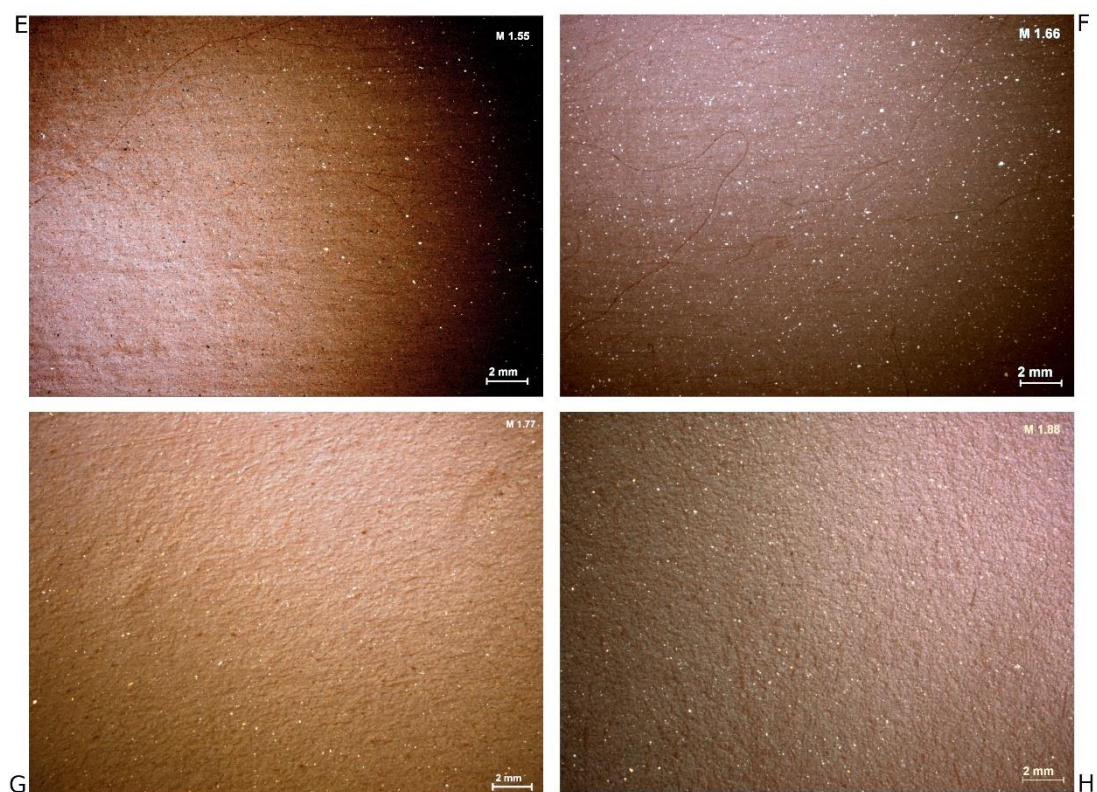
Figura 6.1.62 Evolución de las muestras experimentales trabajadas con manojos de lana. Pasta cerámica industrial. Inversión de trabajo media -5 minutos-. E: consistencia húmeda; F: consistencia cuero-verde; G: consistencia cuero-duro; H: consistencia seca
