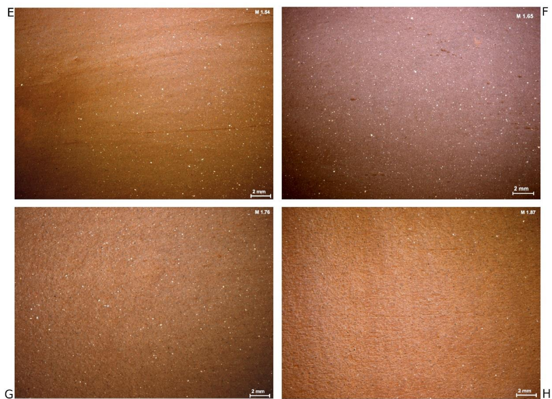
Figura 6.1.56 Evolución de las muestras experimentales trabajadas con fragmento de cuero. Pasta cerámica industrial. Inversión de trabajo media -5 minutos-. E: consistencia húmeda; F: consistencia cuero-verde; G: consistencia cuero-duro; H: consistencia seca
