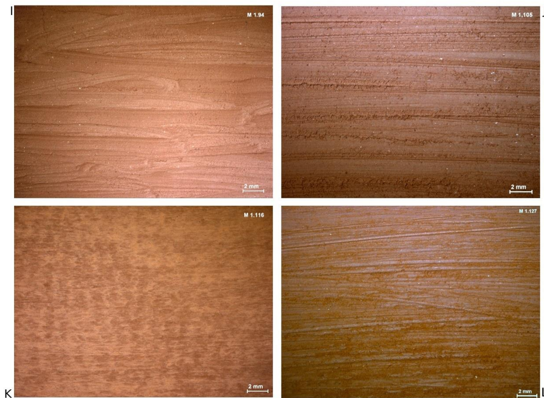
Figura 6.1.33 Evolución de las muestras experimentales trabajadas con espátula en cerámica. Pasta cerámica industrial. Inversión de trabajo elevada -10 minutos-. I: consistencia húmeda; J: consistencia cuero-verde; K: consistencia cuero-duro; L: consistencia seca
