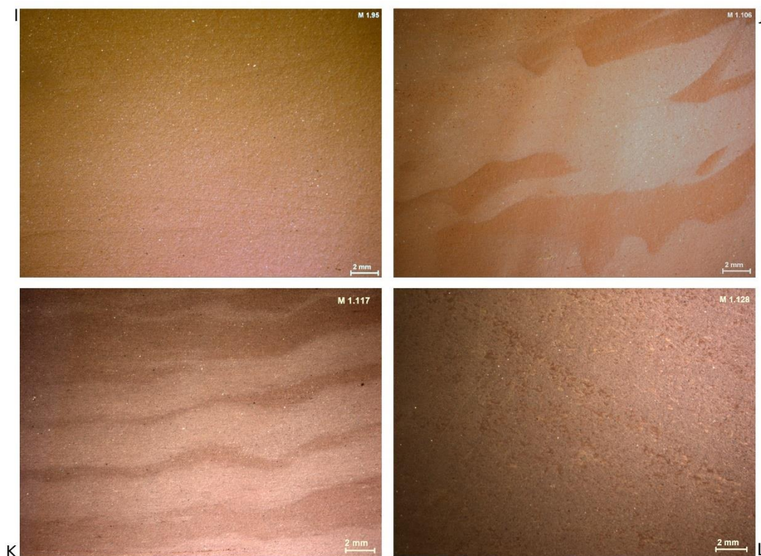
Figura 6.1.39 Evolución de las muestras experimentales trabajadas con espátula en madera. Pasta cerámica industrial. Inversión de trabajo elevada -10 minutos-. I: consistencia húmeda; J: consistencia cuero-verde; K: consistencia cuero-duro; L: consistencia seca
