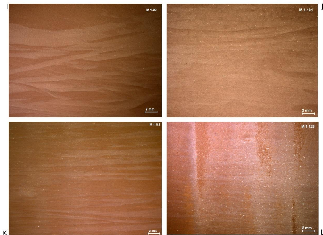
Figura 6.1.9 Evolución de las muestras experimentales trabajadas con espátula en sílex. Pasta cerámica industrial. Inversión de trabajo elevada -10 minutos-. I: consistencia húmeda; J: consistencia cuero-verde; K: consistencia cuero-duro; L: consistencia seca
