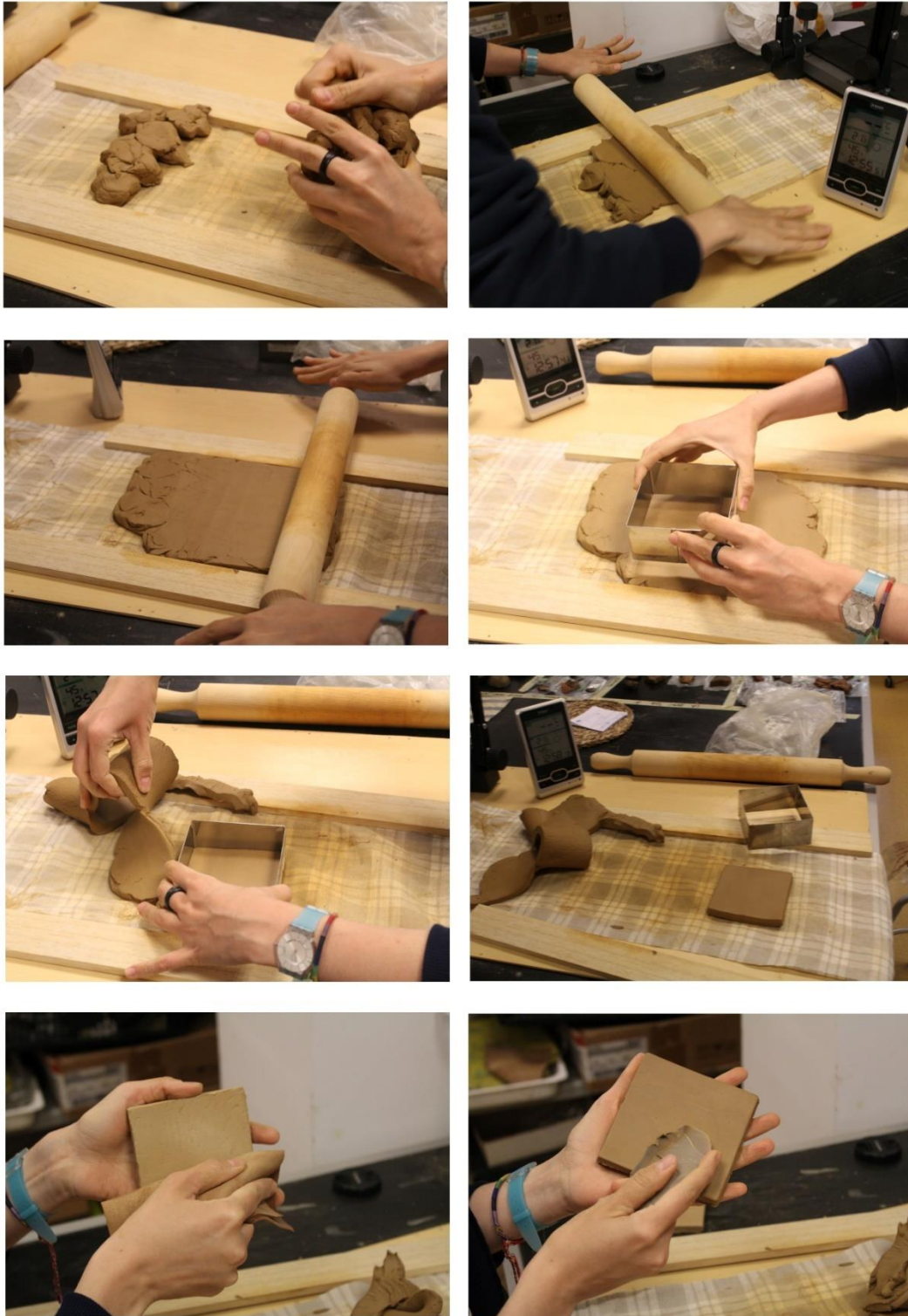
Figura 5.16 Proceso de elaboración y trabajo de las muestras experimentales que componen la colección de referencia
