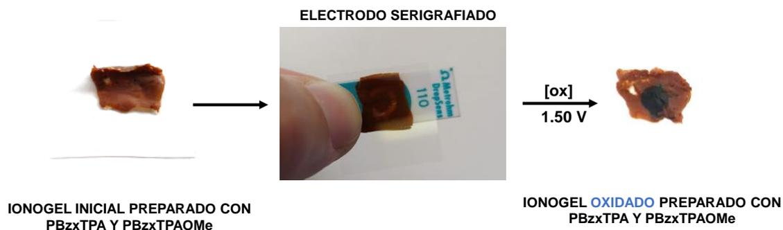
**Esquema 67.** Proceso de oxidación de los ionogeles 1:5:1 P(VDF-co-HFP):BMIM TFSI:PBzxTPAOMe y 1:5:1 P(VDF-co-HFP):BMIM TFSI:PBzxTPA.
