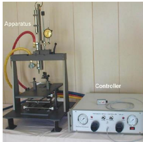
Figura 5. Dispositivo de impacto cortical controlado (Ma et al., 2019).
