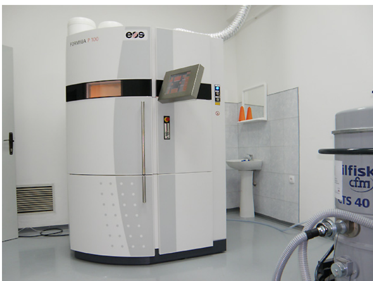
Figura 16. Impresora de sinterización por láser (SLS). Imagen obtenida de http://3dimpuls.com/index.php/en/book/export/html/84
