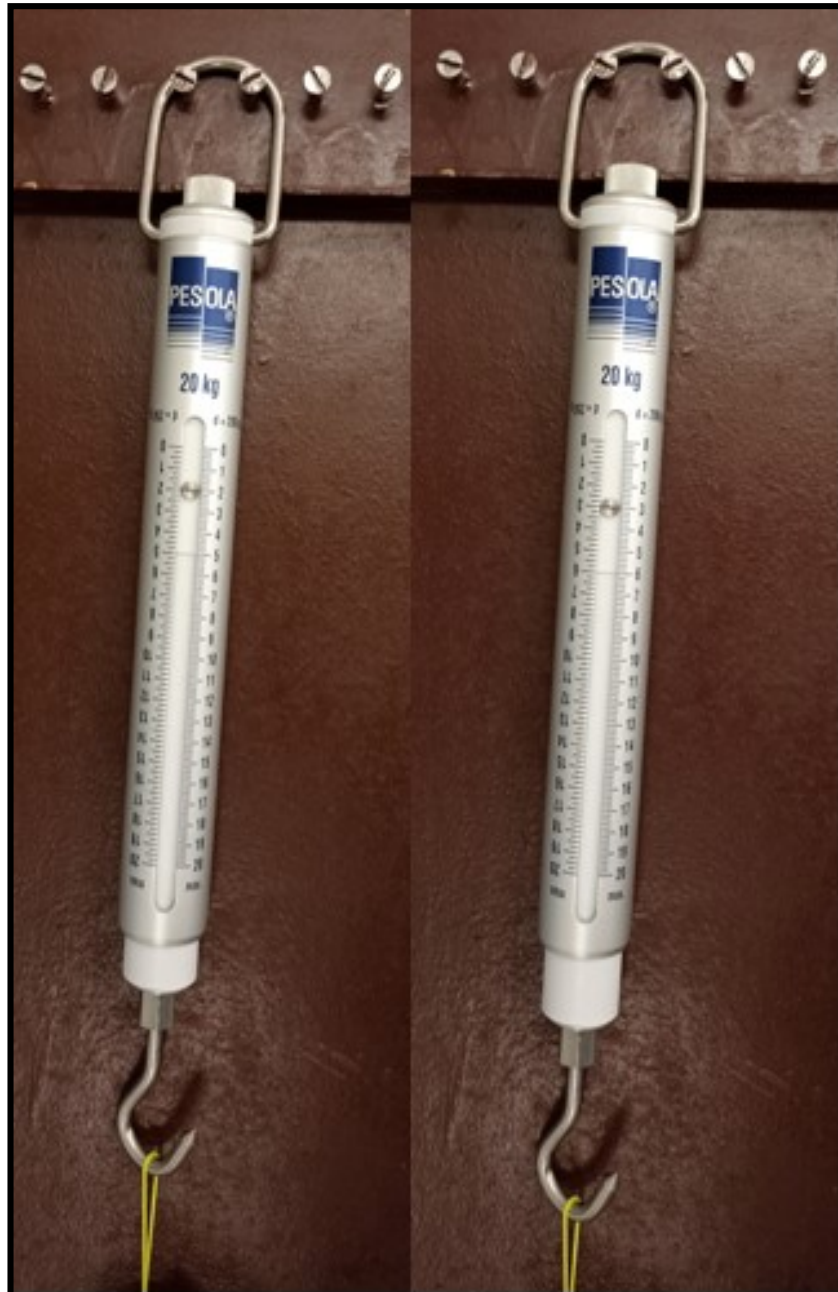
Fig. 6. Aparato de medida de la carga ejercida sobre el ligamento con 2 y 3 kg, respectivamente.
