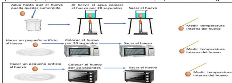
Experimento ejemplificador: uso del horno microondas como ejemplo de eficiencia energética
