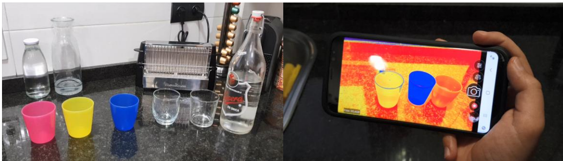
Figura 4.3.D - Estudiantes diseñan un experimento con vasos de distintos colores y temperaturas para evaluar si la App responde al calor real o solo altera los colores.
