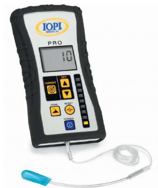
Figura 1. Instrumento IOPI Pro con bulbo para medición de presión lingual.
