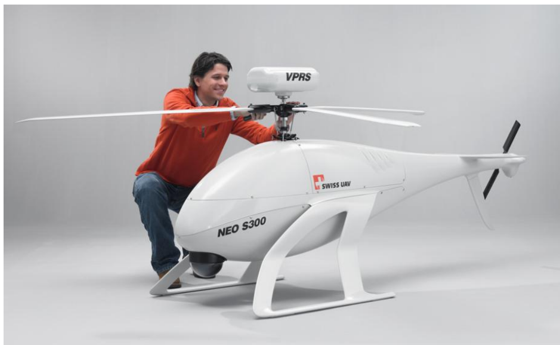
Fig. 6 – Neo S-300, MTOM de 100 Kg, carga de pago de 35 Kg, segmento Light
