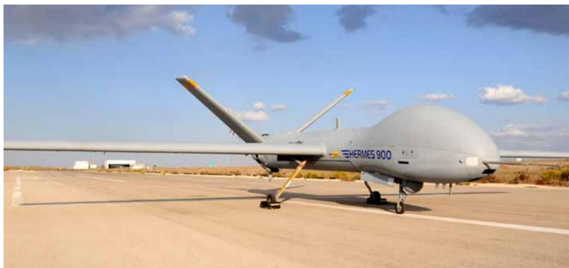
Fig. 7 – Hermes 900 de Elbit Systems, MTOM 1.180 Kg, carga de pago 350 kg, segmento MALE
