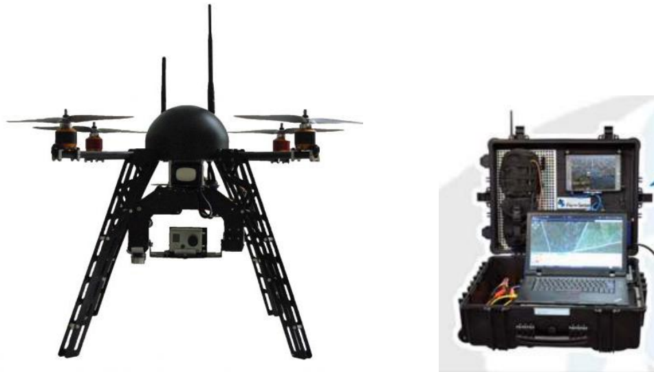
Fig. 4 – Micro UAS de Fly-n-Sense, y consola de control portátil
