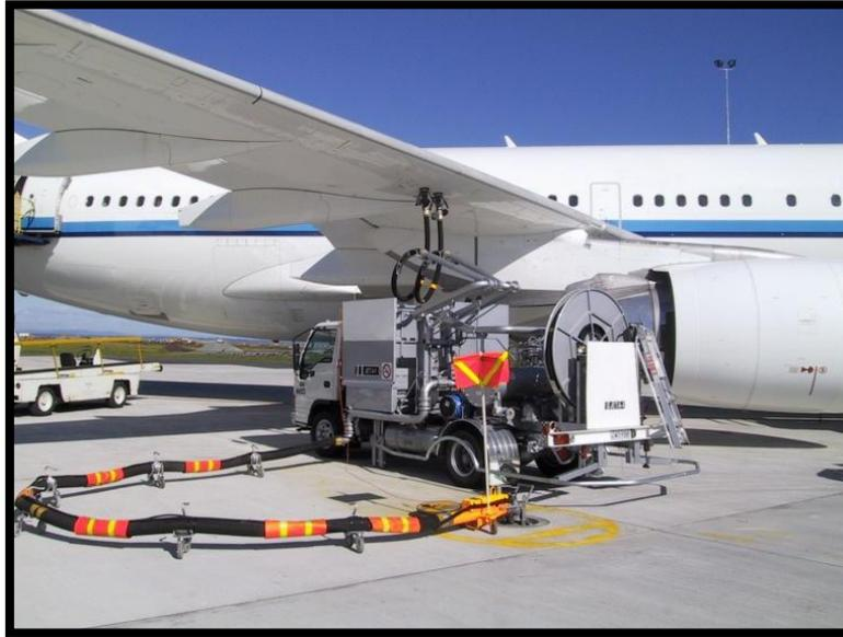
Il·lustració 10: Equip de transferència de combustible des de la plataforma.
