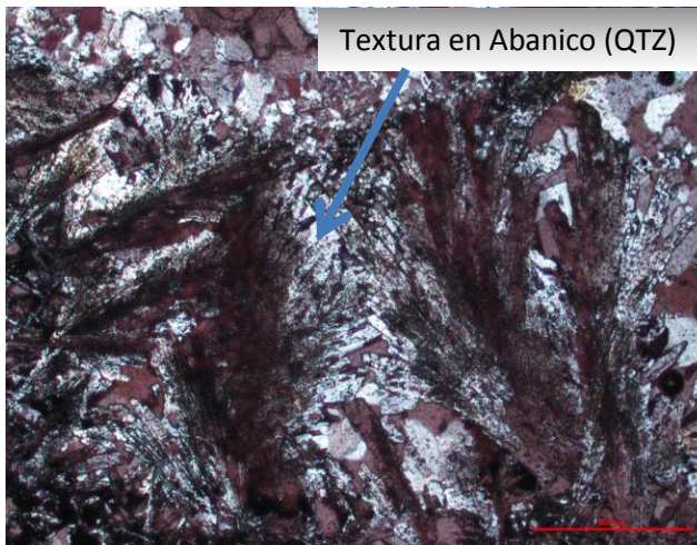
Figura 6. A (arriba): textura en abanico del cuarzo con nicos cruzados. B (abajo): igual que A pero con nicos paralelos.
