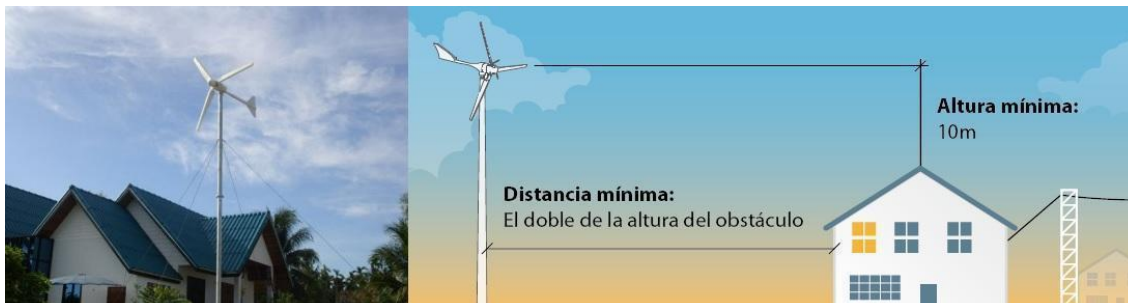
Imatge 6. Aerogenerador domèstic i la distància entre l'aparell i l'habitatge. windspot.es
