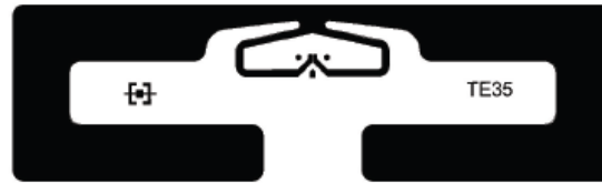
Figura 10. Aspecto físico del tag TE35, de Traceteck-ID. Fuente
