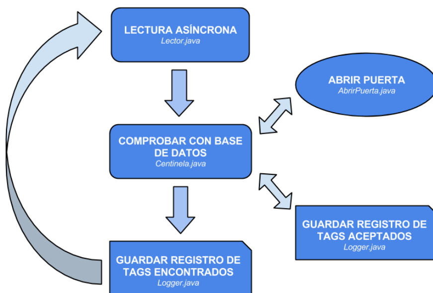
Figura 24. Esquema básico del funcionamiento del sistema de lectura de tags
