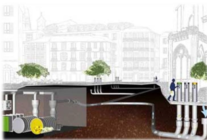
Figura I.3.4: Sistema de recollida pneumàtica al carrer. Font: Agència Catalana de Residus
