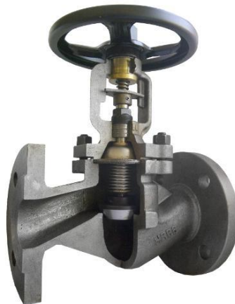
Figura 4.5 Válvula de asiento o de globo.
