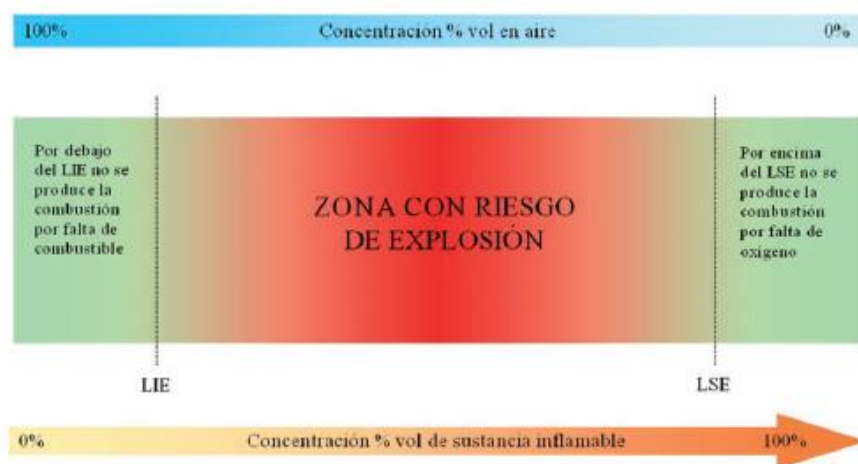
Figura 5-16. Zona amb risc d'explosió
