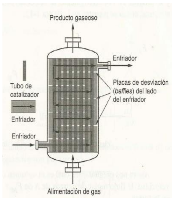
Figura 2.8. Reactor catalítico longitudinal de lecho empacado
