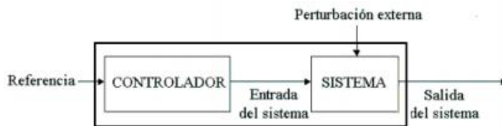
Figura 3.1. Esquema de un sistema de lazo abierto.
