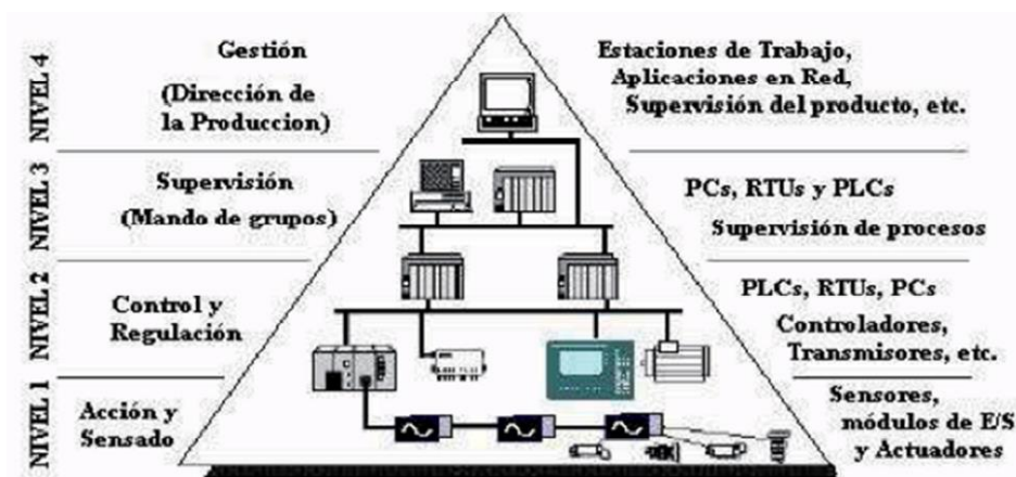
Figura 3.4. Esquema de un centro de control piramidal.
