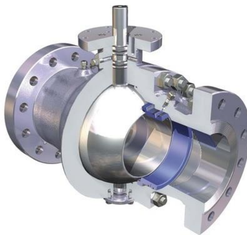
Figura 4.2.2.1.1. Esquema d'una vàlvula de bola
