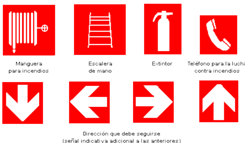
Figura 5-4 Señales relativas a los equipos de lucha contra incendios
