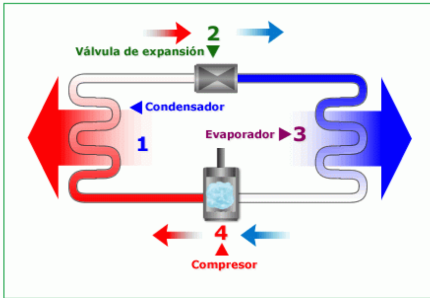
Figura 1.39 Etapes del cicle frigorífic del chiller.
