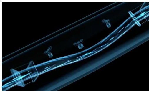
Figura 3-19 Principi de funcionament d'un mesurador d'efecte Coriolis
