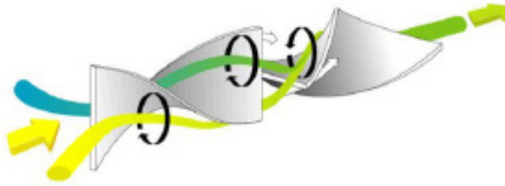
Figura 2 9. Funcionament intern d'un mesclador en línia o estàtic.
