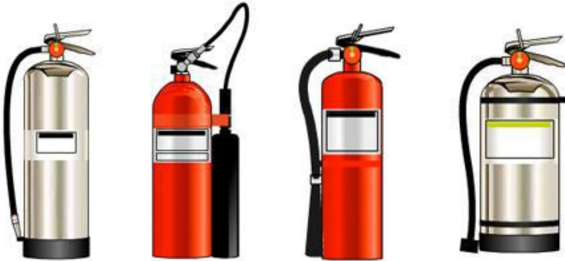
Figura5.16.- Extintors d'aigua i escuma, extintors de diòxid de carboni, extintors de pols químics secs i extintors químics humits respectivament.
