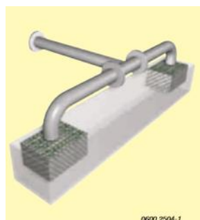
Figura 11.7.7. Tipus d'entrada d'alimentació utilitzada, empresa Sulzer.
