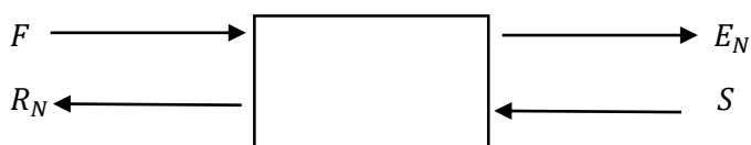
Figura 11.8.5. Esquema simplificat de l'extracció amb les entrades i sortides corresponents.
