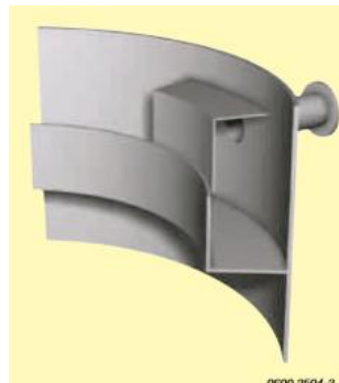
Figura 11.7.11. Tipus d'entrada d'alimentació, empresa Sulzer.
