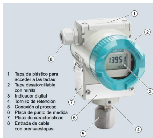
Ilustración 7 Transmisor de presión SITRANS P310 utilizado en la planta.
