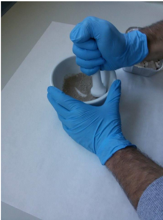
Figura 4.1. Pretractament dels llots, fase de trituració i homogeneïtzació
