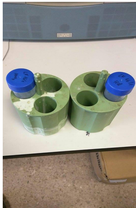
Figura 4.7. Mostres essent col·locades en les cubetes del centrifugador de manera equilibrada en massa
