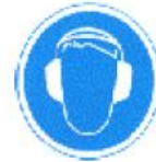
Protecció obligatòria de l'oïda
