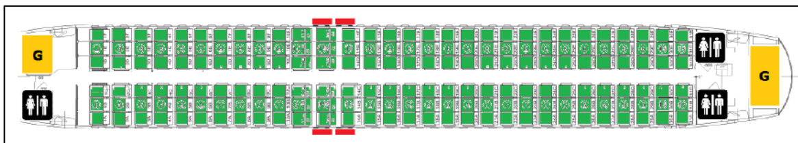
Figura 14: Esquema de los asientos del A320 con configuración 180Y
