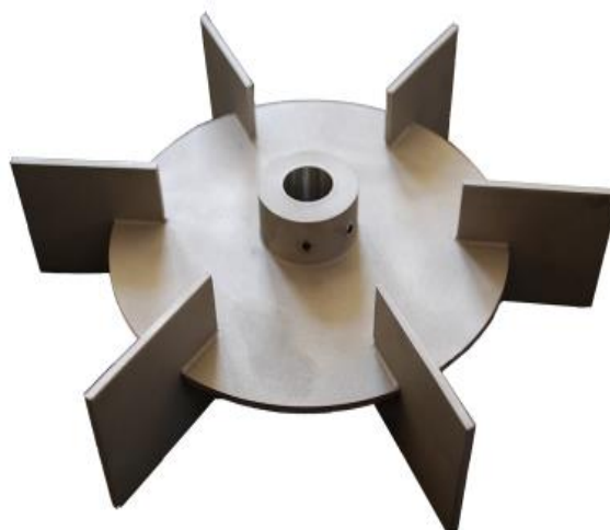
Figura 11.3-2. Turbina amb sis làmines planes muntades en un disc
